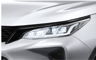
LED Head Lamps Design ไฟหน้า Full LED แบบ Dual Projector พร้อม Daytime Running Lights
