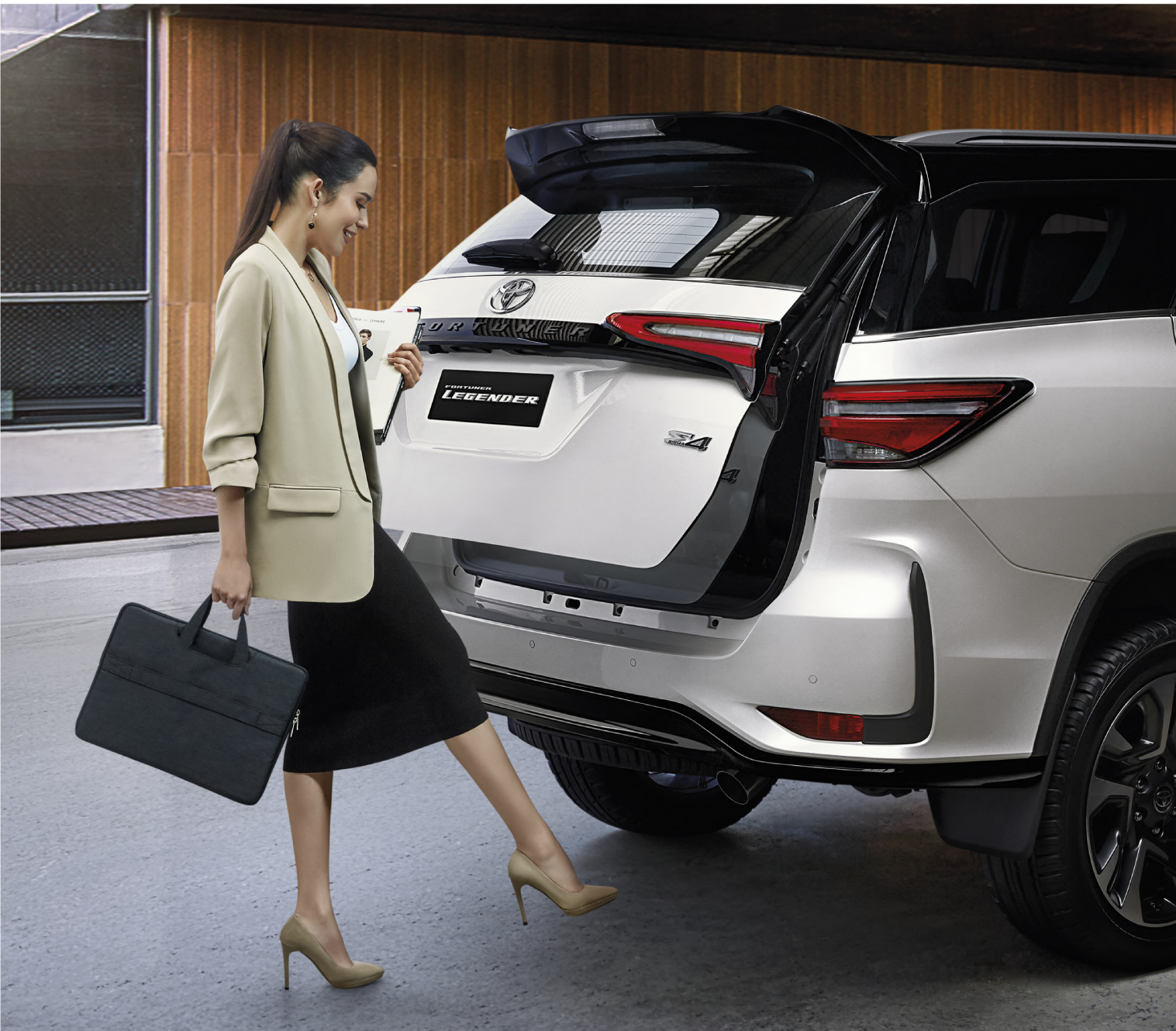
Kick Activated Back Door V.2 พบบเวอร์ชิ้นใหม่ของประตูท้ายเปิด-ปิด ด้วยไฟฟ้าพร้อมชุดเซ็นเซอร์ และระบบป้องกันการหนีบ ตอบรับทุกไลฟ์สไตล์ส่งคุณได้ดีขึ้น
