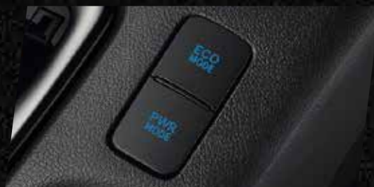
สวิตช์ปรับรูปแบบการขับขี่ เลือกได้ทั้งแบบประหยัด (ECO Mode) และแบบสมรรถนะสูง (Power Mode)
